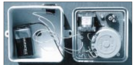
Bild 4: Aufbau des Summers in einem Weich-PVC-Gehäuse
