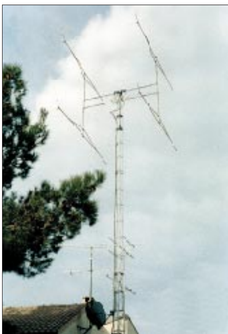
Michel, F1FIH, ist regelmäßig aus JN23GS während der Perseiden in SSB aktiv. Er arbeitet auf 2 m mit 4 x 16-Ele.-Yagis von F9FT.
