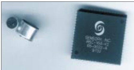
Bild 1: Der RSC164 im 68poligen PLCC-Gehäuse neben einigen Elektretmikrofonkapseln
