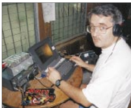
Tom, DJ6TF, an der Station. Über dem Transceiver ein Tiefpaßfilter und ein BCC-Preselektor, beide bereits im FA vorgestellt und unabdingbar für den gleichzeitigen Betrieb von mehreren Stationen
