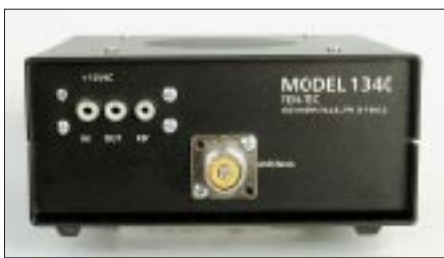
Die Rückseite bietet noch Platz zum Einbau eines RX-HF-Abschwächerpotentiometers.
