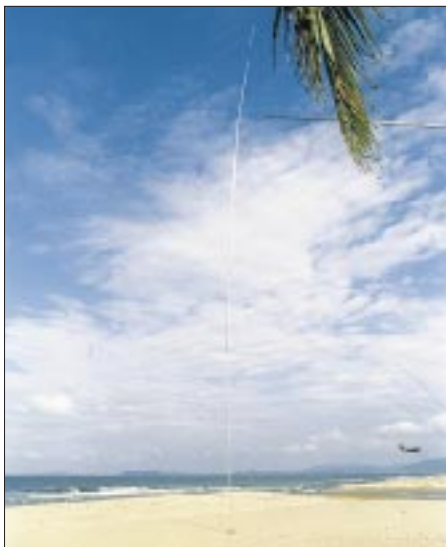
Freier Blick für die Vertikal V80E. An der Spitze sind die Drähte der Dachkapazität für 160 m befestigt, die bei 80-m-Betrieb einfach an den Mast gelegt und unten leitfähig mit ihm verbunden wurden.
